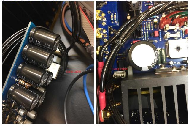
6. From the transformer, there is a 6 pins connector as shown on the below left picture; connect it to the connector on the DAC board as shown on the left picture. 전원 연결: 아래 사진처럼 파워 트랜스포머에 있는 6가닥의 케이블을 DAC 보드의 6핀자에 연결하십시오.
