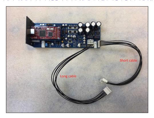
3. Remove the cover on the back panel for the DAC board, and install the DAC board as shown below. 본체 후면의 DAC 삽입구를 열고 사진 처럼 DAC 보드를 설치하십시오.
