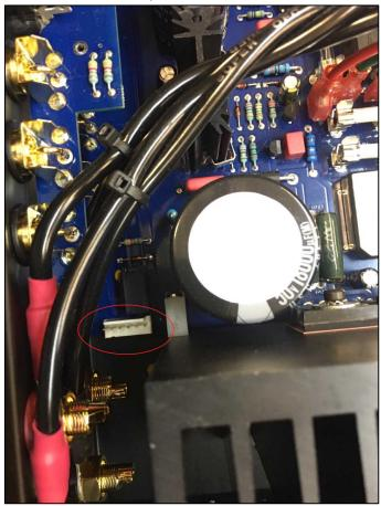
The below pictures show the long cable from the DAC board installed on the mother board. 아래 사진은 긴 케이블이 제대로 연결된 DAC보드와 메인 보드를 보여 줍니다.
