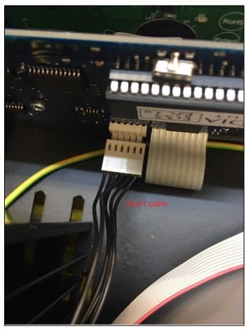
5. As shown on the below picture, localize the connector on the mother board, and connect the long cable from the DAC board to that connector. 아래 사진처럼 메인보드의 연결단자를 찾은 다음, 긴 케이블을 그 단자에 연결하십시오.
